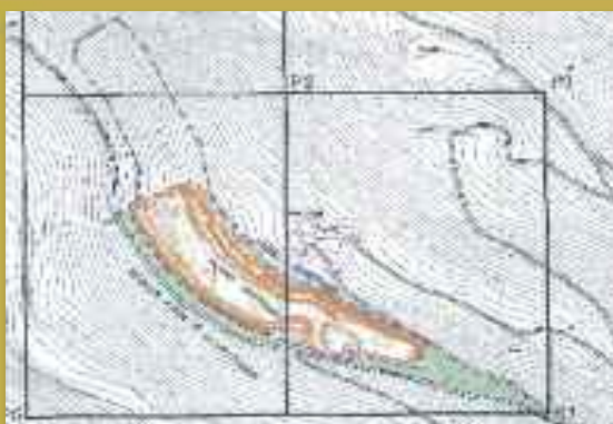
Gaur egungo harrobiak eta handitzeak hartuko lukeen eremua ikus daiteke goiko planoan. Berdez dago ustiatu gabe utzitako eremua, inpaktua gutxitzeko.
